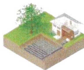
Pompe à chaleur sur capteurs enterrés horizontaux
