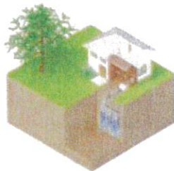
Pompe à chaleur sur corbeilles géothermiques
